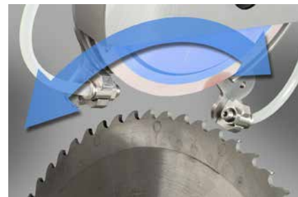
Chanframento automático da serra – Giro do cabeçote de afiação
