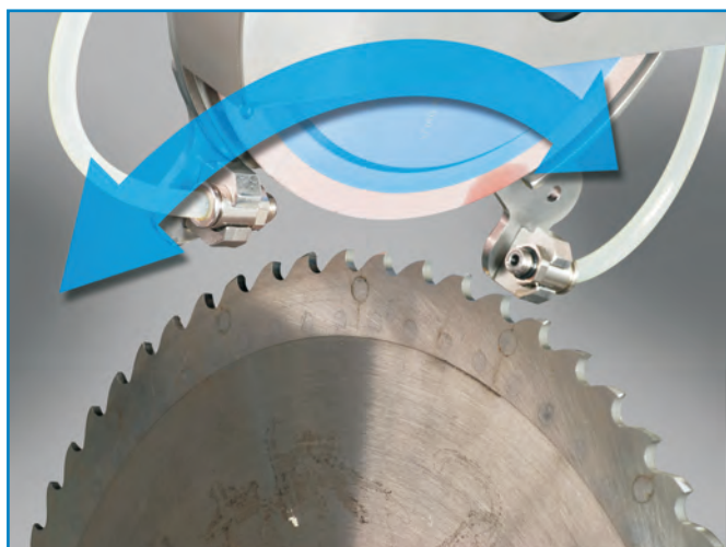
Obrót głowicy szlifującej w procesie automatycznego fazowania
