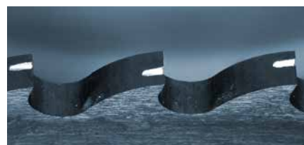
Dente curvo con canali rompi-truciolo
