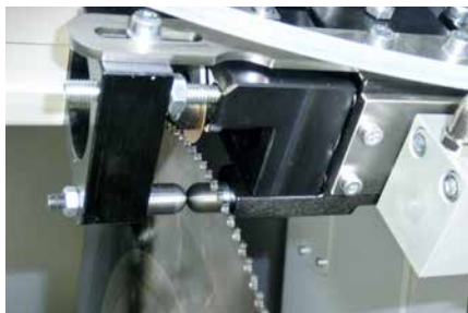
Affûtage des rainures brise-copeaux
