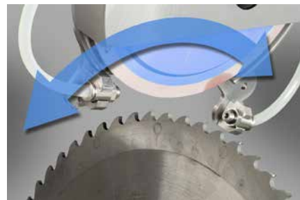
Chanfreinage en mode automatique d'une fraise-scie / basculement de la tête d'affûtage
