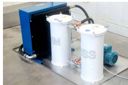
Filtration avec filtre pour carbure et / ou filtre pour HSS climatisée
