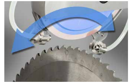
Biselado automático de la hoja de sierra – movimiento giratorio del abezal de afilado
