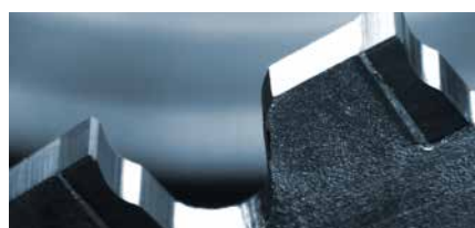
Diente HW de una sierra de corte fino con rompevirutas (sierra TK)
