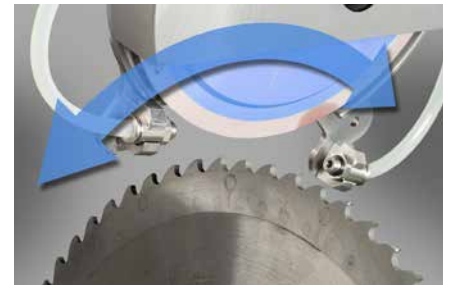
Automatisches Anfasen des Sägeblattes – Schleifkopf Schwenkbewegung
