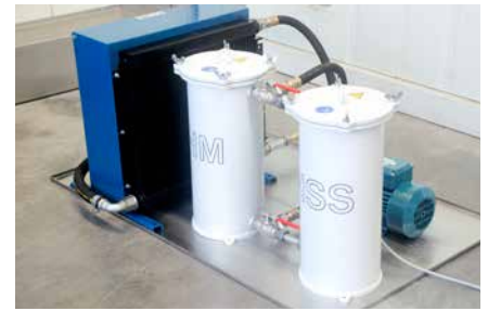
Externer HSS- u. HM-Feinstfilter mit Kühlgerät
