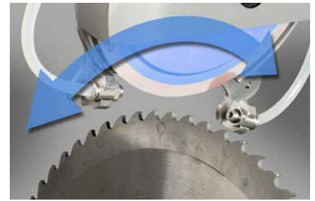
Automatisches Anfasen des Sägeblattes – Schleifkopf Schwenkbewegung
