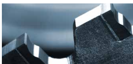
HW-Zahn einer Dünnschnittsäge mit Spanleitstufe (TK-Säge)
