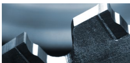
Dentes de metal duro com guia-cavaco (tipo serra TK)
