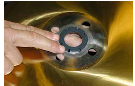
Reduzerring zur Anpassung des Sägeblattbohrungsdurchmessers
