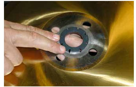
Reduzerring zur Anpassung des Sägeblattbohrungsdurchmessers
