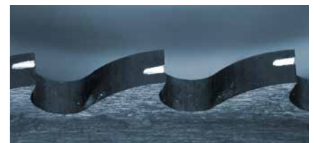
Denture acmé avec rainures brise-copeaux
