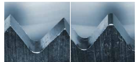
Denture triangulaire/Denture isocèle
