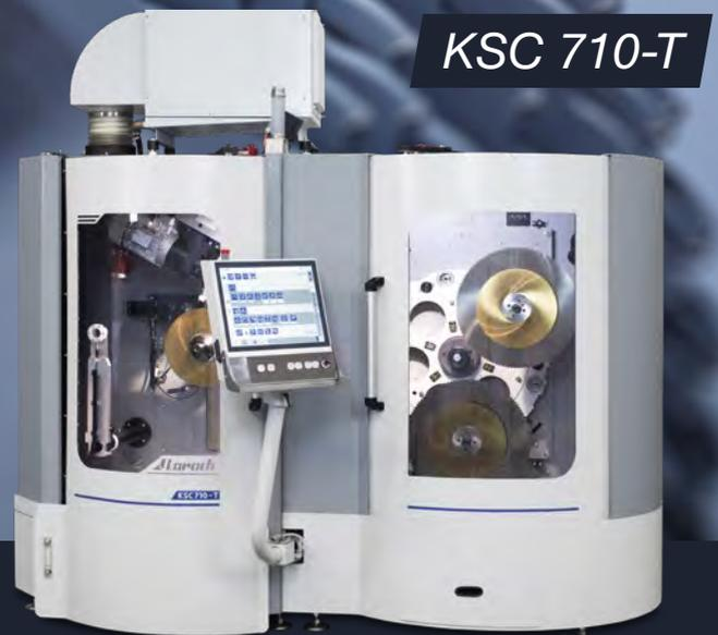
Mit dem Loroch Maschinenkonzept KSC sind Dünnschnittsägen wirtschaftlich nachschleifbar. Die Vorteile der Touch-Steuerung sowie der Konturfahrt machen sich in der kürzeren Prozesszeit gegenüber anderen Technologien bemerkbar.
