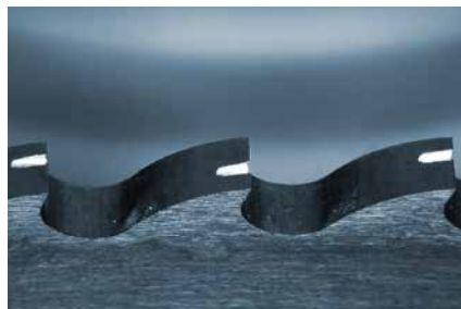
Bogenzahn mit Spanteilerrille
