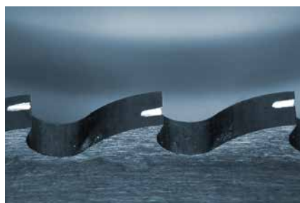
Dente curvo con canalini rompitruciolo
