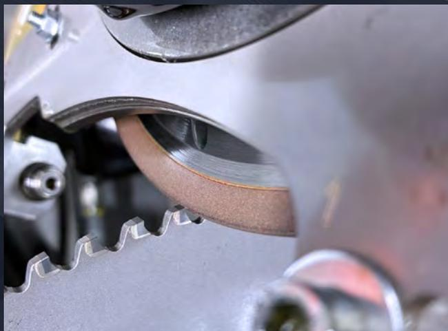
Der Startpunkt für die Bearbeitung wird zuverlässig und präzise mit Hilfe eines Körperschallsensors ermittelt.
