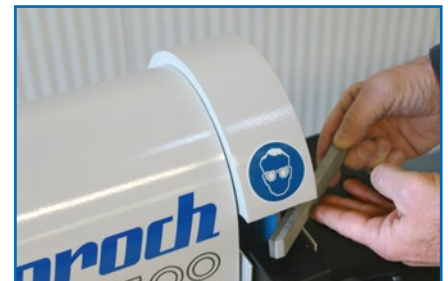
Abrichten einer CBN-Schleifscheibe
