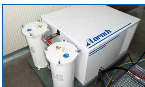
Filtration avec filtre pour carbure et/ou filtre pour HSS climatisée
