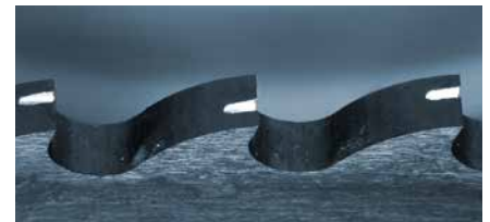
Bogenzahn mit Spanteilerrille
