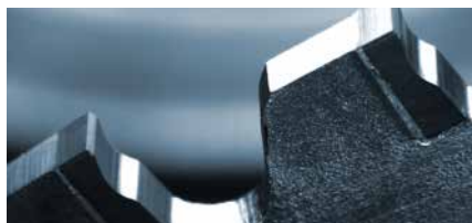
HW-Zahn einer Dünnschnittsäge mit Spanleitstufe (TK-Säge)
