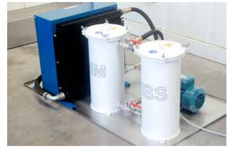
Externer HSS- u. HM-Feinstfilter mit Kühlgerät
