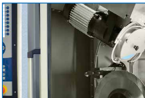
Прямой привод шлифовального круга
