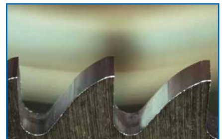
Зуб фрикционной пилы „Клюв попугая“
