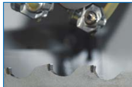
Sierra con placa de metal duro
