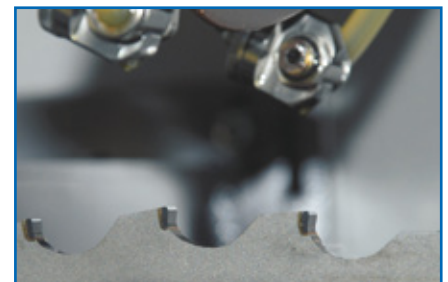
Scie circulaire au carbure avec chanfrein de dégagement de copeaux
