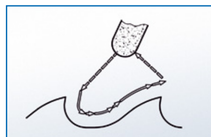
Траектория движения шлиф. Головки при заточке пил CV (Хром-Ванадиевых)
