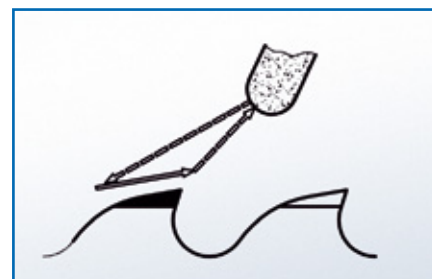
Траектория движения шлиф. Головки при заточке пил Би-металлических
